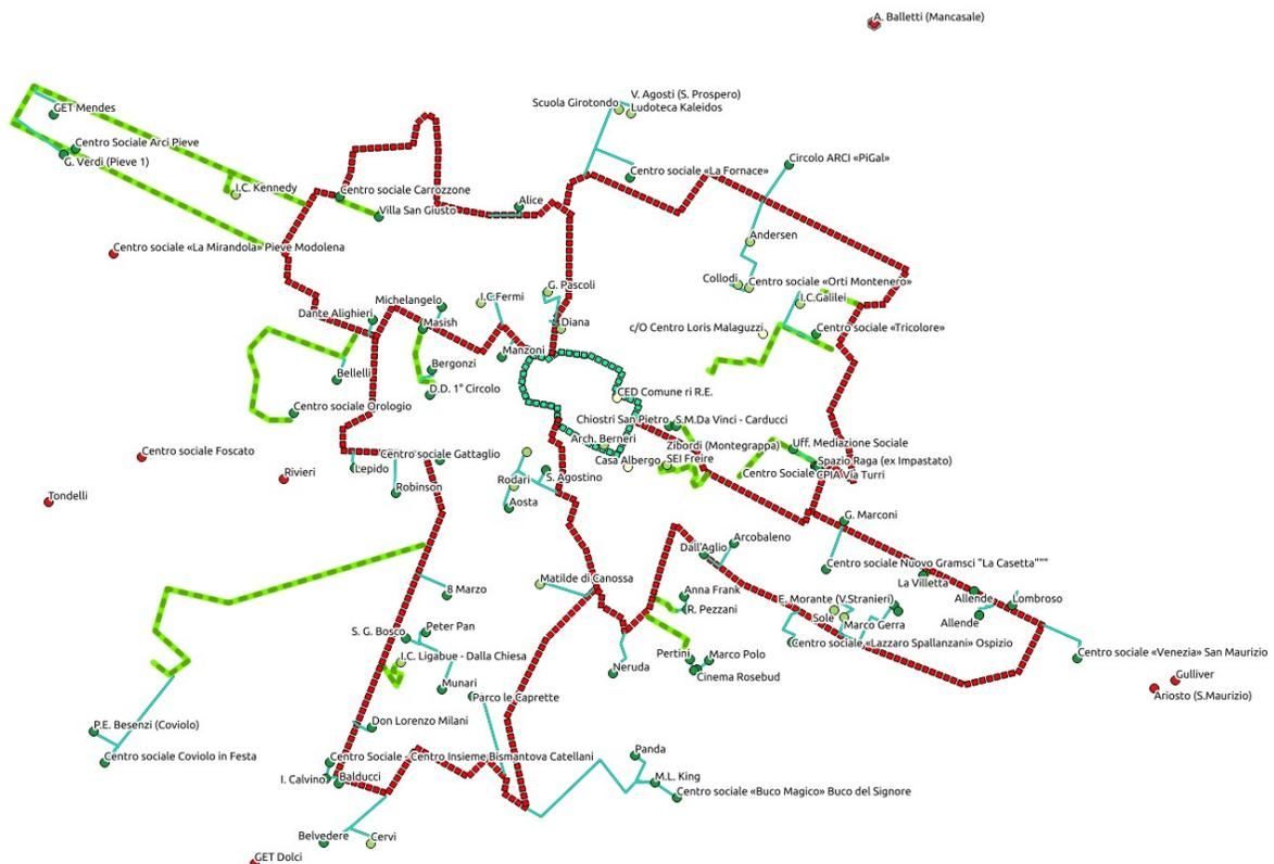
Gli Sbracci di dorsale sono una struttura formata da rilegamenti puntuali o circolari che rappresentano estensioni della struttura di dorsale. Tale struttura sarà realizzata con cavi in fibra ottica con potenzialità pari a 144 fibre.
